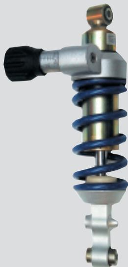
*Ammortizzatore con regolazione precarica idraulica molla e regolazione in distensione*
